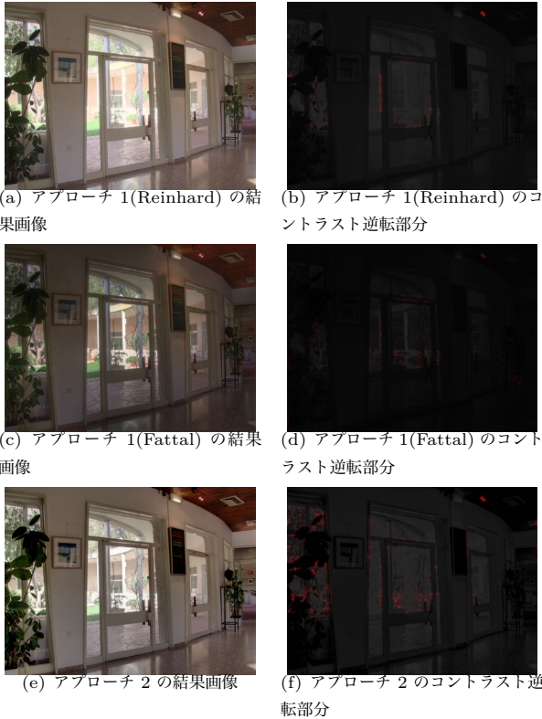
図 6 5 枚で合成した高品質画像のコントラストの逆転部分
