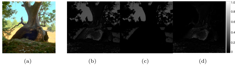
図 3 "Tree"におけるトーンマッピング後の純色の差。(a)TMO を使用した後丸め量子化およびクリッピング処理を行った LDR 画像，(b)HDR 画像との純色の差（丸め量子化およびクリッピング処理の両方を実施），(c)HDR 画像との純色の差（クリッピング処理のみ実施），(d)HDR 画像との純色の差（丸め量子化のみ実施）
